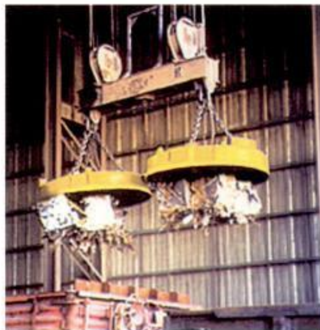
Ein magnetiskur krani hevur eina sterka elektromagnet, har sum aðrir kranar hava krók. Kranin á myndini hevur tvær elektromagnetir.
