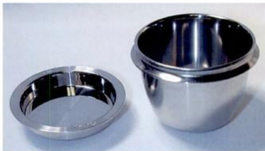
Diglar úr platini. Hesir diglarnir verða brúktir til evnafrøðiligar kanningar.
