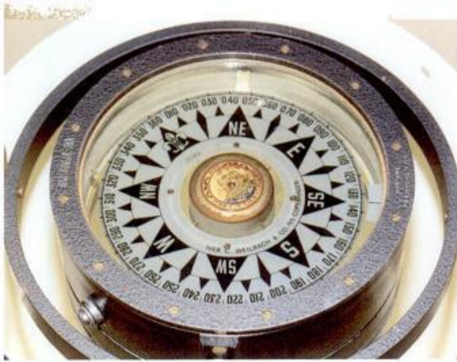
Skipskumpass. Ein skiva, nevnd kumpassrósa, sum vísir ættirnar, er fest niður á magnetnálinu.
