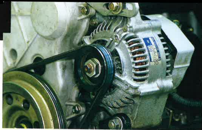
Vekselstrømsgenerator i bil. Bilens motor trækker en kilerem, der drejer generatorens aksel.
