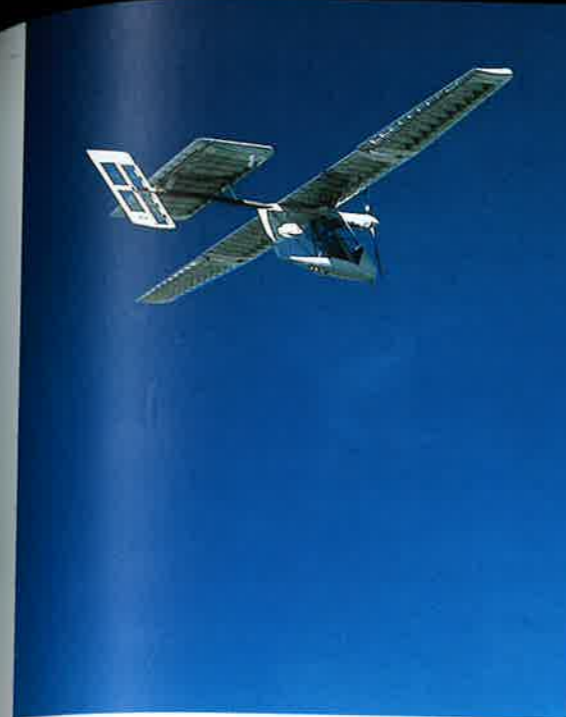
Enmandsflyet Solar Challenger, som drives af solceller på vingerne. Det kan flyve med en fart af 200 km/time.
