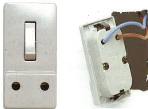
En stikkontakt set forfra og bagfra. Faseledningen (brun) har gennem den indbyggede afbryder forbindelse til stikkontaktens venstre hul.
