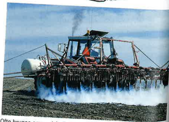
Ofte bruges ammoniak direkte som gødning. Ammoniakken spredes med en maskine, som samtidig fræser den ned i jorden. Hvis ammoniakken bare blev spredt ud over marken, ville den hurtigt fordampe og gå tabt for planterne.
