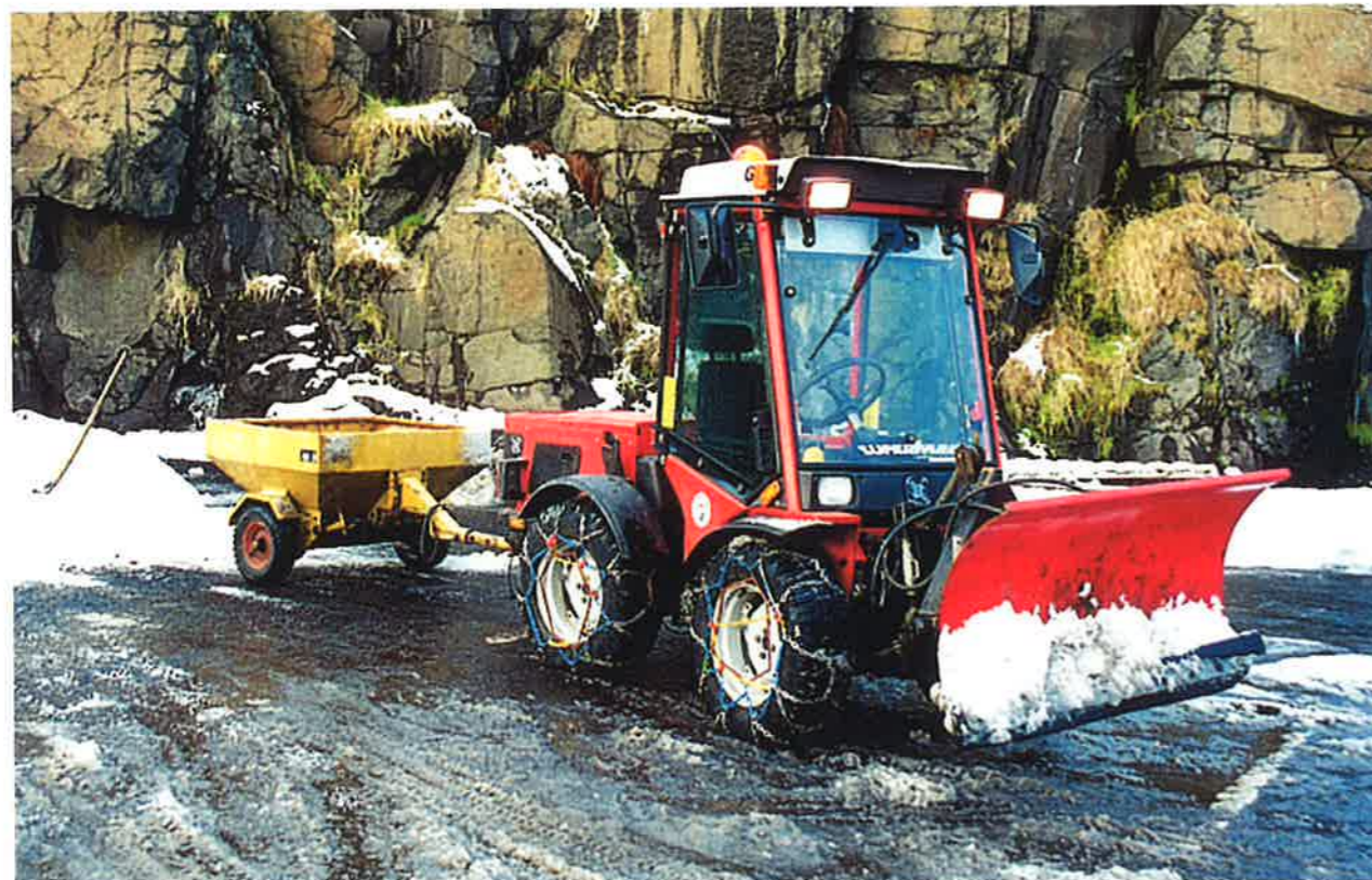
Lítill traktorur við kavaplógv og saltstroyara viðfestum. Aftast saltrúgvan.
