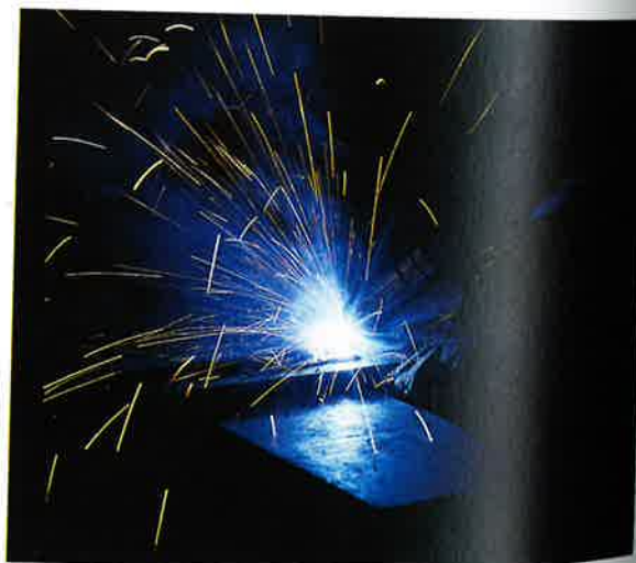
Ved elektrosvæjsning af jernplader anvender man en lignende teknik, som vi anvendte til oversmeltning af et søm. Ved at transformere til lavspænding opnår man så store strømstyrker, at man kan svejse jernplader sammen.
