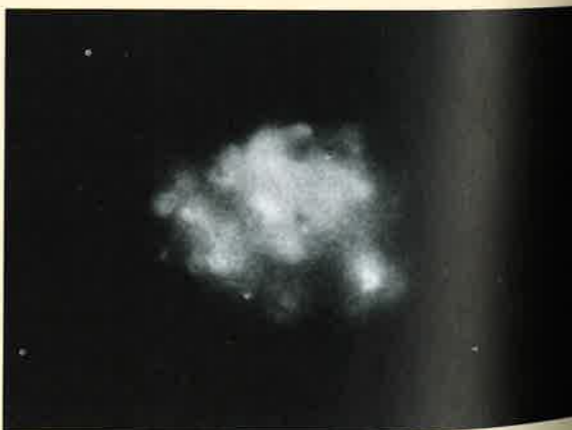
Et radioaktivt salt anbragt oven på en fotografisk film, som er indpakket i sort lyst papir. Strålerne fra det radioaktive stof trænger igennem det sorte papir og påvirker filmen. Billedet til højre viser filmen efter fremkaldelsen. Det var på denne måde franskmænden Becquerel i 1896 opdagede de radioaktive stoffer.
