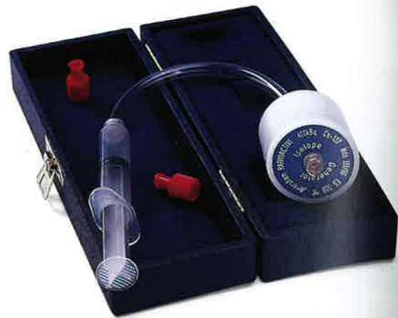
Minigenerator. Saltsyre presses langsomt gennem minigeneratoren. Når syren drypper ud forned, er der opløst et radioaktivt stof i den.
