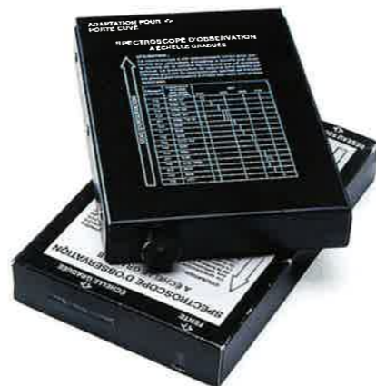
Simpelt håndspektrometer til måling af lysets bølgelængde. På tegningen nedenfor kan du se, hvordan det fungerer.
