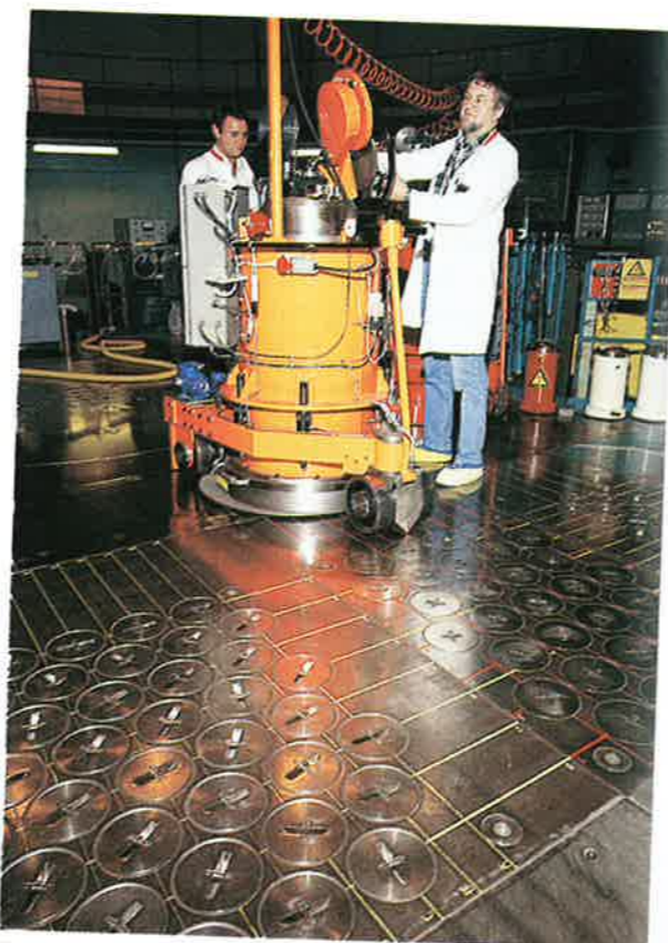
Billedet viser toppen af atomreaktoren DR3 på Risø. Reaktoren anvendes hovedsageligt til bestråling af forskellige stoffer. For eksempel fremstiller man her ca. en femtedel af al det neutronbestrålede silicium, som i hele verden anvendes til computerchips, m.m. Siliciumstængerne føres ind i reaktoren ved hjælp af det apparatur, som ses midt i billedet.
