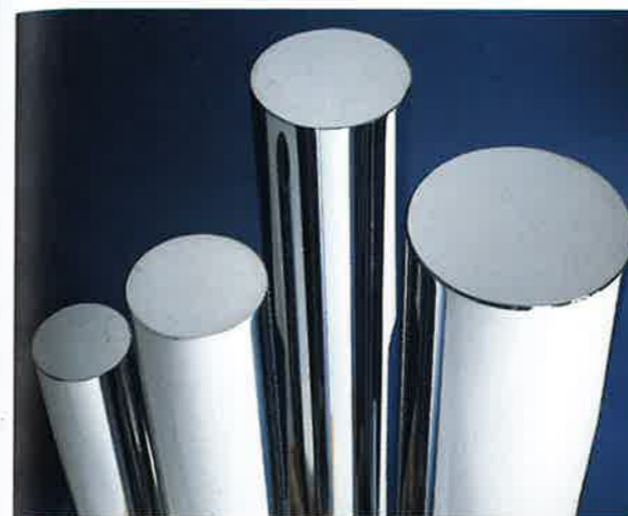
På fabrikken Topsil i Frederiksværk fremstiller man de stænger af rent silicium, som på forsøgsstation Risø skal udsættes for neutronbestråling for at kunne bruges til elektroniske komponenter. Stængerne er omkring 10 cm tykke og op til 60 cm lange.
