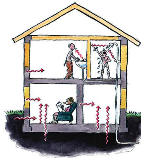
Billedet viser, hvordan luftarten radon trænger ind i et hus. Noget kommer op fra undergrunden gennem sprækker i gulvet. Noget kan komme med vandet, og noget siver ud fra byggematerialerne.
